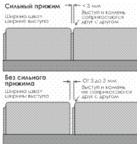
Рис. 48. Следует избегать укладки камней/плит с большим прижимным усилием
