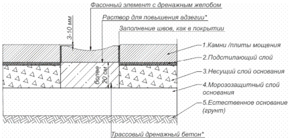
Рис. 37 Схема установки бортового камня
