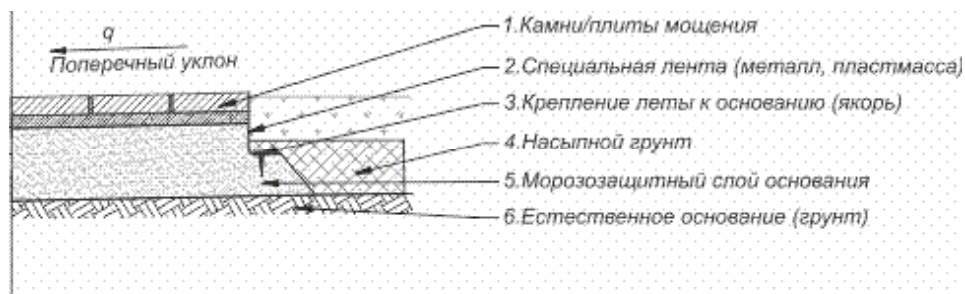
Рис. 34. Закрепление краев с применением металлических и пластиковых лент
